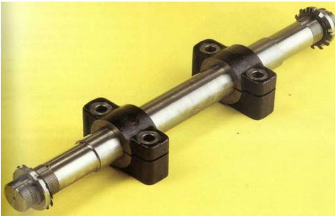
Achszusammenstellungen für die paarweise Montage von Räder ausgestattet mit Kugel- oder Kegelrollenlagern. Durch Sperrmutter und Sperrscheibe werden Kegelrollenlager fixiert.
