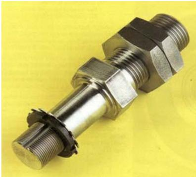
Dieses Sortiment an Achsstummel ist für die Befestigung einzelner Räder mit Kugel- oder Kegelrollenlager bestimmt, durch Sperrmutter und Sperrscheibe werden Kegelrollenlager fixiert.
