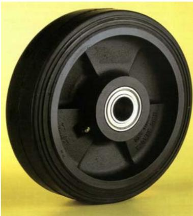
Gummiräder sind die günstigsten Räder mit Beschichtung und für mäßige Lasten geeignet. Leiser Lauf, schonend für den Untergrund, nicht Abriebfest. Gummiräder können statische Elektrizität erzeugen - wo das nicht erwünscht ist, können antistatische Reifen angewendet werden.
